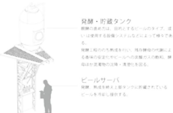
この建築は固定の店舗と仮設店舗の中間に位置し、各地の醸造家に対し提案するものである。分解・再構築が容易なユニットで構成され固定だけでなく、サーカス小屋のように移動も可能な設計としている。工業的機能美を備えた醸造設備を木の構造体で包み込む。醸造空間と暮らしとをつなぐ縁側設計、醸造工程の全てを社会に対して公開する。
